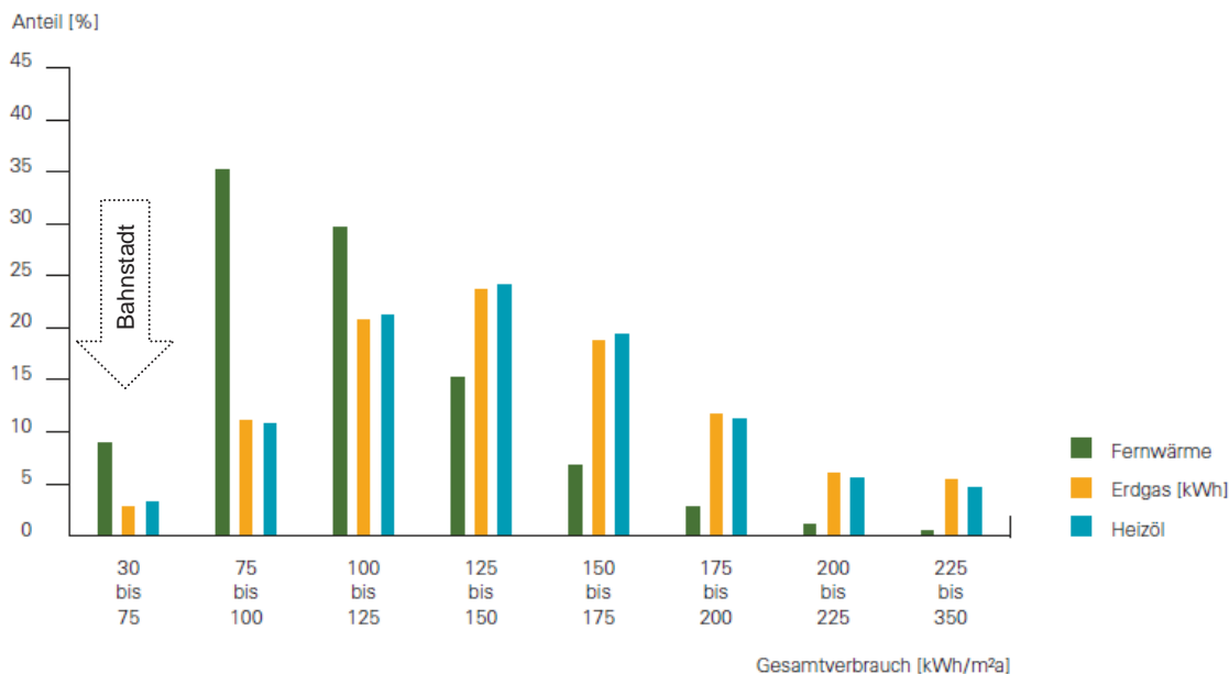
Abbildung 11: Häufigkeitsverteilung des spezifischen Gesamtverbrauchs in verbundenen Anlagen im Bundesdurchschnitt, Bezug auf Wohnfläche (aus [Techem 2017], nicht witterungsbereinigt)
